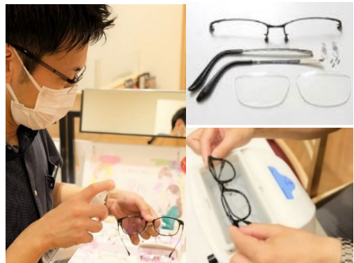
メガネを完全分解し、超音波洗浄。 仕上げに、除菌効果の高い、 次亜塩素酸水溶液のスプレーをメガネ全体に噴霧
