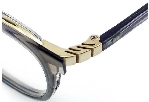
ヒンジに刻まれたスリットが弾力性を生み、かけ心地だけでなく型崩れの防止にも
